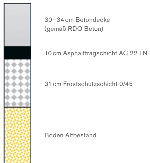
Aufbau Gesamtquerschnitt ZOB Singen
