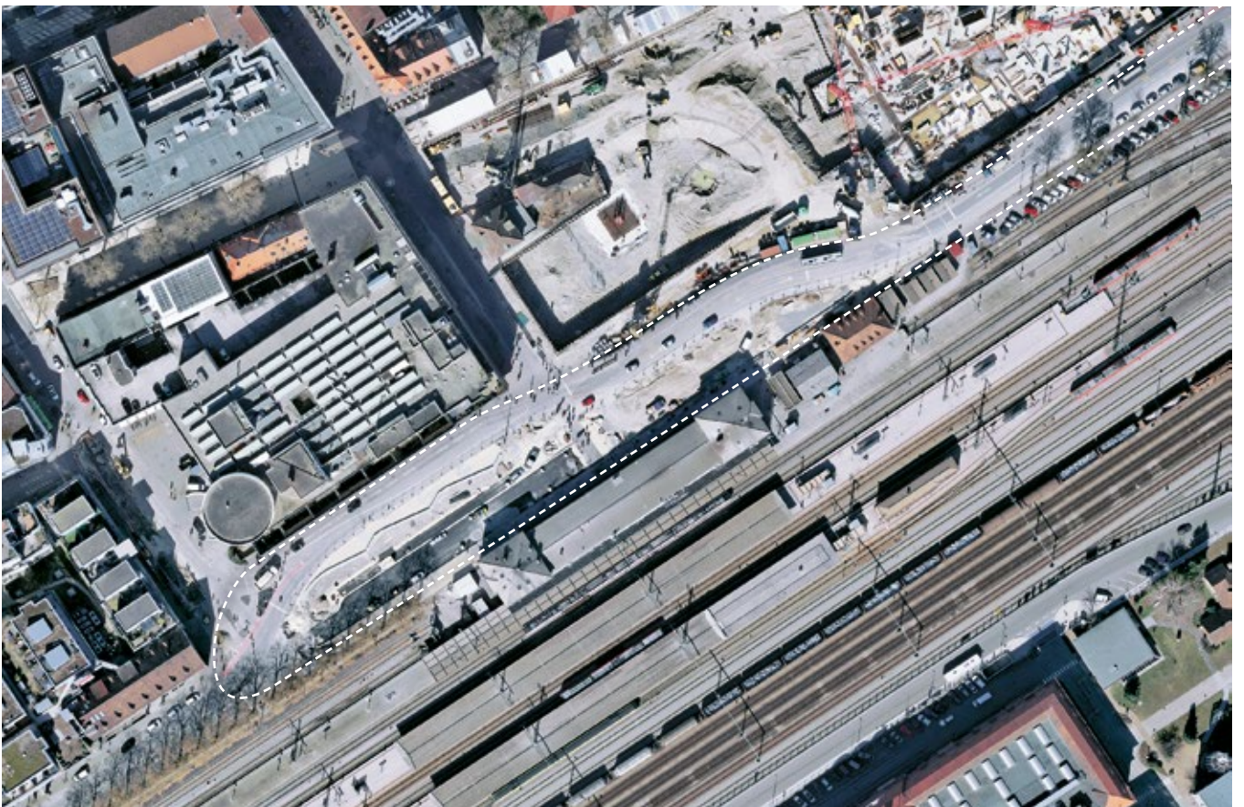
Luftbild während des Umbaus. Gestrichelte Linie: gesamte Baumaßnahme inkl. ZOB, bei welcher Beton als Straßenbelag verwendet wurde.
