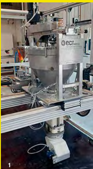
1 + 2 3D-Druckversuche mit Transportbeton an der TU Dresden.
