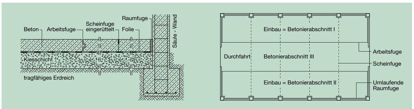
Bild 2: Betonfußboden mit Fugenarten und Feldeinteilung der Betonierabschnitte
