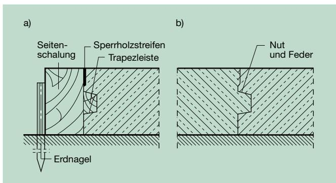
Bild 3: Arbeitsfuge mit Nut und Feder zur Querkraftübertragung
