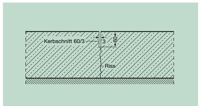
Bild 4: Scheinfuge mit einfacher Fugenkerbe ohne Fugenverguss
