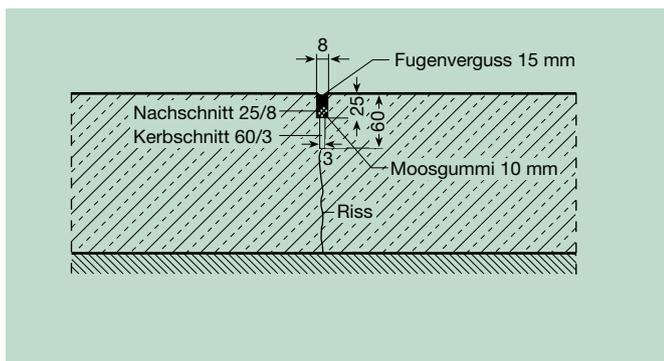
Bild 5: Scheinfuge mit Fugenkerbe einschließlich Nachschnitt und Fugenverguss
