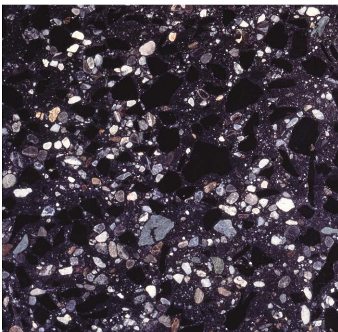
Bild 12: Oberfläche geschliffen, imprägniert, Kunstmuseum Liechtenstein in Vaduz, 2000, Architekten: Morger & Degelo, Basel / Christian Kerez, Zürich
